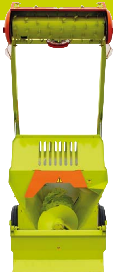
Dispositivo automatico di aggancio ruspa per la protezione della fresa durante la circolazione su terreni sconnessi
