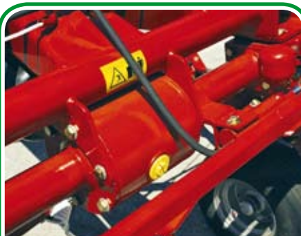
Inclinazione ruote idraulica Hydraulic wheel inclination Inclinaison roue hydraulique
