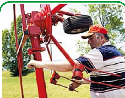
Rotazione della girante esterna verso l'interno in posizione di trasporto - Outer rotor rotates inwards in the transport position - Rotation de la toupie externe vers l'intérieur en position de transport
