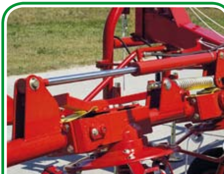
Cilindro di sollevamento idraulico per posizione di trasporto - Hydraulic hoisting cylinder for transport position - Cylindre de soulèvement hydraulique pour position transport
