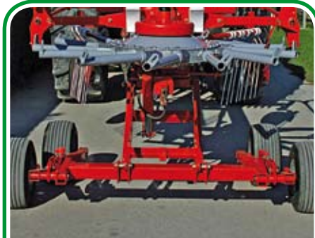
Regolazione idraulica altezza di lavoro 430 12V Hydraulic working height adjustment 430 12V Régulation hydraulique hauteur de travail 430 12V
