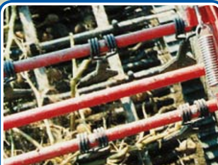
Nastro defogliatore a maglie larghe che avvolge il nastro elevatore. - Wide mesh leaf removing belt that surrounds the elevator belt. - Tapis effaneur à mailles larges qui enveloppe le tapis élévateur.
