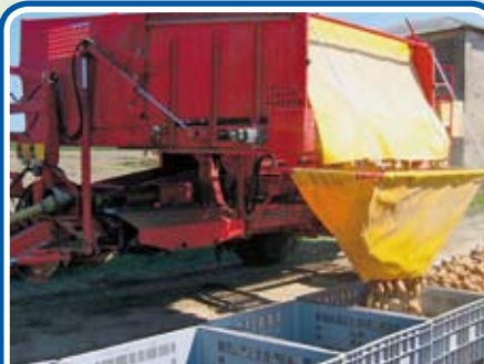
Scarico tramoggia in bins con telone ad imbuto. - Hopper unloading into bins using funnel tarpaulin. - Déchargement trémie en bacs avec entonnoir en toile.
