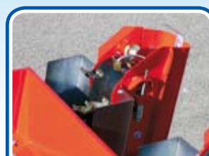
Elevatore a tazze con cinghie in gomma doppio rango. - Bucket elevator with double Rank rubber belts. - Élévateur à godets avec courroies en caoutchouc double rangée.
