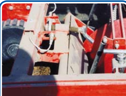
Controllo automatico della profondità di scavo. - Automatic digging depth control. - Contrôle automatique de la profondeur de creusement.
