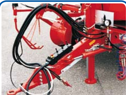
Barra di traino; per aggancio inferiore. - Hitch bar; for lower coupling. - Barre de traction; pour attelage inférieur.
