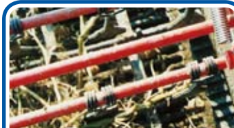
Nastro defogliatore a maglie larghe che avvolge il nastro elevatore - Wide mesh leaf removing belt that surrounds the elevator belt - Bande effaneuse à mailles larges qui enveloppe le tapis élévateur
