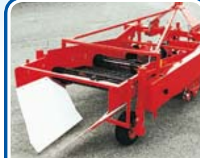
Code andanatrici regolabili in teflon, 2 ruote di livello, 2 nastri setacciatori (opt) - Adjustable swath forming extensions in Teflon, 2 levelling wheels, 2 sieving belts (opt) - Queues d'andainage réglables en téflon, 2 roues de niveau, 2 tapis de tamisage (opt)
