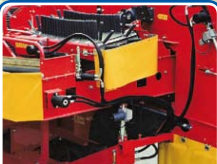
Particolare riccio di separazione. - Detail of separating star roller. - Détail tapis à têtes de séparation.
