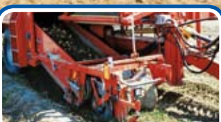
Pick-up tastatore (opt) - Feeler pick-up (opt) - Dispositif d'arrachage palpeur (opt)
