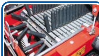
Separazione del prodotto, sistema P.D.R. - Product separation, P.D.R. system - Séparation du produit, système P.D.R. (peigne doigts rotatifs)
