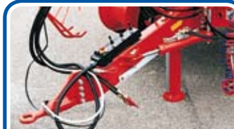
Barra di traino; per aggancio inferiore - Hitch bar; for lower coupling - Barre de traction; pour attelage inférieure
