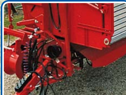
Particolare del timone e della centralina di comando da portare in cabina. - Detail of the drawbar and the control box to be brought inside the cabin. - Détail du timon et de l'unité de commandes à mettre en cabine.
