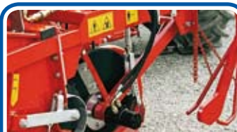
2 rulli tirafoglie, direzione automatica canale di setacciamento - 2 leaf pulling rollers, automatic direction of the sieving channel - 2 rouleaux tire-fanes, direction automatique canal de tamisage
