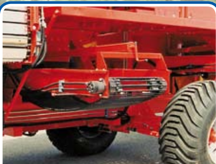
Convogliatore laterale di scarico. - Side discard conveyor. - Convoyeur latéral de déchargement.
