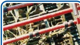
Nastro defogliatore a maglie larghe che avvolge il nastro elevatore - Wide mesh leaf removing belt that surrounds the elevator belt - Tapis effaneur à mailles larges qui enveloppe le tapis élévateur
