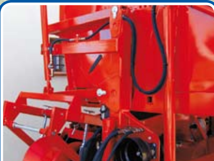
Particolare della tramoggia fondo mobile. - Detail of hopper with movable bottom. - Détail de la trémie à fond mobile.
