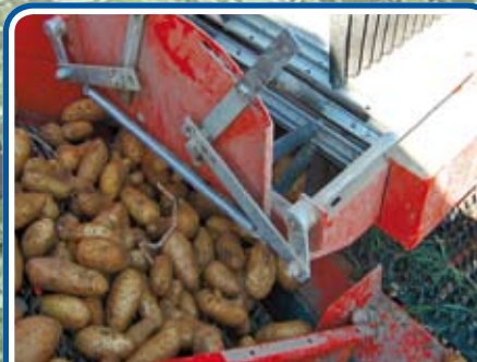
Particolare dita riccio di separazione. - Detail of separating star roller fingers. - Détail doigt tapis à têtes.
