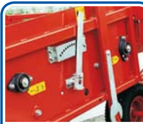
Manovelle di comando agitatori ad intensità regolabile - Agitator control crank with adjustable intensity - Manivelles de commande secoueurs à intensité réglable
