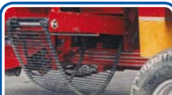
Sistema di recupero delle patate piccole costituito da serbatoio posto sotto i rulli cernitori e nastro di evacuazione a trazione idraulica - Small potato recovery system that includes a tank under the sorting rollers and the hydraulically driven evacuation belt - Système de récupération des petites pommes de terre constitué par un réservoir placé sous les rouleaux de triage et tapis d'évacuation à traction hydraulique
