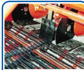
2 vomeri a 3 lame e 1° nastro setacciatore a barrette intercalate (opt) - Two 3 blade ploughs and one sieving belt with inserted bars (opt) - 2 socs à 3 lames et 1er tapis de tamisage à barrettes intercalées (opt)
