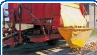
Scarico tramoggia in bins con telone ad imbuto - Hopper unloading into bins using funnel tarpaulin - Déchargement trémie en bacs avec entonnoir en toile
