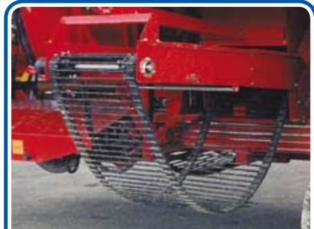
Sistema di recupero delle patate piccole costituito da serbatoio posto sotto i rulli cernitori e nastro di evacuazione a trazione idraulica - Small potato recovery system that includes a tank under the sorting rollers and the hydraulically driven evacuation belt. - Système de récupération des petites pommes de terre constitué par un réservoir situé sous les rouleaux de triage et tapis d'évacuation à traction hydraulique.
