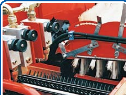
Separazione del prodotto, sistema N.S.R. - Product separation, N.S.R. system. - Séparation du produit, système N.S.R. (tapis à brosses rotatives).
